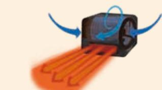
コンパクトボディの内部に持つ大きな風洞で、温風を力強く排出する「贅沢大風量」が特徴。セラミックヒーターにありがちな「近くの人だけ暖かい」を解消しました。
