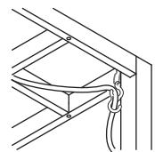
電源コードを固定せずに使用すると、断線やショートを引き起こし、火災や感電、故障の原因になります。
