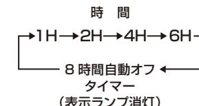
※この商品は、切り忘れ防止のための8時間自動オフタイマーを搭載しています。切タイマーを設定していないなくても、最後に操作してから8時間経過すると自動的に運転を停止します。なお、この機能は解除できません。
