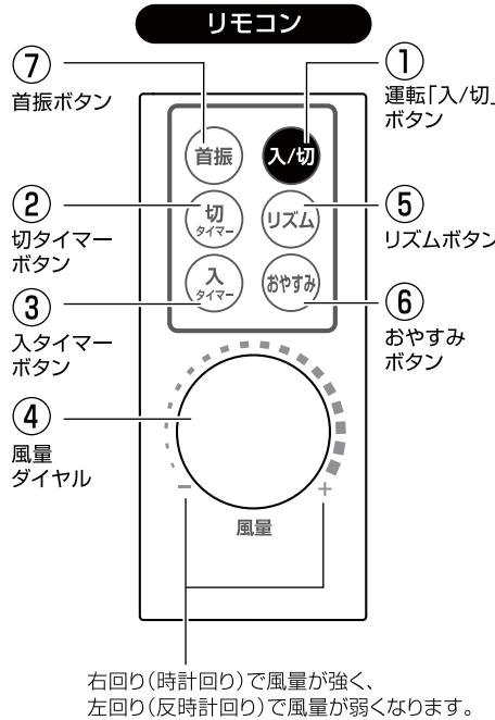
右回り(時計回り)で風量が強く、左回り(反時計回り)で風量が弱くなります。
