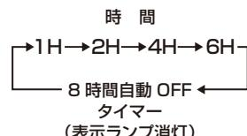
※この商品は、切り忘れ防止のための8時間自動OFFタイマーを搭載しています。切タイマーを設定していくなくても、最後に操作してから8時間経過すると自動的に運転を停止します。なお、この機能は解除できません。
