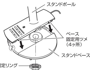
③固定リングをスタンドポール底部に取り付け、時計方向に回して締め付け、確実に固定してください。
