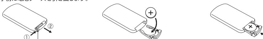
\* 長時間使わないときは電池を取り出してください。(液漏れによる故障を防ぎます)
