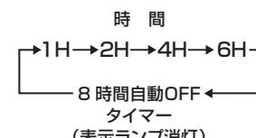
※この商品は、切り忘れ防止のための8時間自動OFFタイマーを搭載しています。切タイマーを設定していないなくても、最後に操作してから8時間経過すると自動的に運転を停止します。なお、この機能は解除できません。
