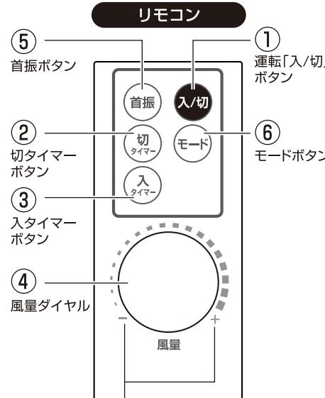
右回り(時計回り)で風量が強く、左回り(反時計回り)で風量が弱くなります。
