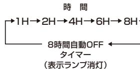
この商品は、切り忘れ防止のための8時間自動OFFタイマーを搭載しています。切タイマーを設定していくなくても、最後に操作してから8時間経過すると自動的に運転を停止します。なお、この機能は解除できません。
