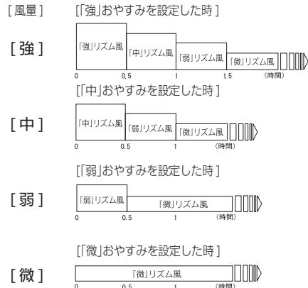
リズム運転、及びおやすみ風運転を開始後に、風量パターン変更するときは、リモコン、及び本体の風量調節バーで行います。
