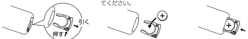
\* 長時間使わないときは電池を取り出してください。(液漏れによる故障を防ぎます)
