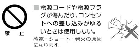
■ 電源コードや電源プラグが傷んだり、コンセントへの差し込みがゆるいときは使用しない。
