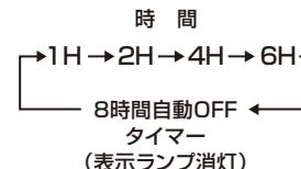
※この商品は、切り忘れ防止のための8時間自動OFFタイマーを搭載しています。切タイマーを設定していなくても、最後に操作してから8時間経過すると自動的に運転を停止します。なお、この機能は解除できません。
