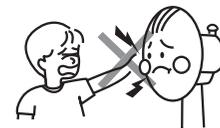
**プラグを持って抜く** 電源プラグを抜くときは、電源コードを持たずに、必ず先端の電源プラグを持って引き抜く。
