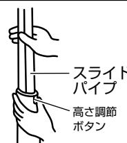
羽根・ガードを付けずに高さ調節ボタンを押したり、モーター部モーターを運転しないでください。
