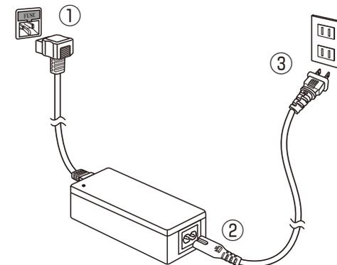
**注意** 電源プラグはコンセントに根元まで確実に差し込む。差し込んででも緩みがある場合は、コンセントに接続しない。
