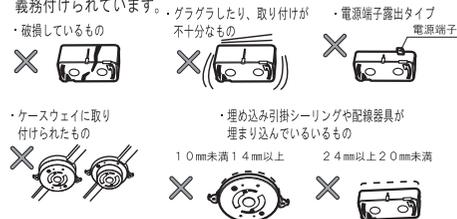
配線器具は必ず丈夫な天井面に確実に取り付けしてください。
