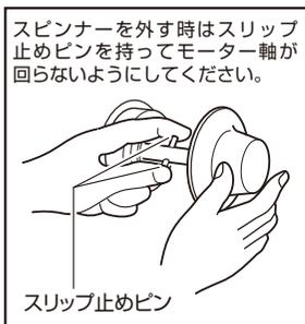
スピナーを外す時はスリップ止めピンを持ってモーター軸が回らないようにしてください。
