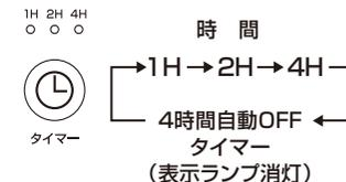
※この商品は、切り忘れ防止のための4時間自動OFFタイマーを搭載しています。タイマーを設定していなくても、最後に操作してから4時間経過すると自動的に運転を停止します。なお、この機能は解除できません。
