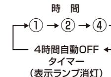
※この商品は、切り忘れ防止のための4時間自動OFFタイマーを搭載しています。タイマーを設定していなくても、最後に操作してから4時間経過すると自動的に運転を停止します。なお、この機能は解除できません。
