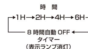
※この商品は、切り忘れ防止のための8時間自動OFFタイマーを搭載しています。切タイマーを設定していない場合、最後に操作してから8時間経過すると自動的に運転を停止します。なお、この機能は解除できません。
