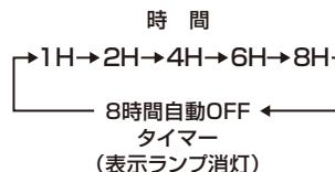
※この商品は、切り忘れ防止のための8時間自動OFFタイマーを搭載しています。切タイマーを設定していくなくても、最後に操作してから8時間経過すると自動的に運転を停止します。なお、この機能は解除できません。
