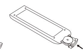
※長時間使わないときは電池を取り出してください。(液漏れによる故障を防ぎます)
