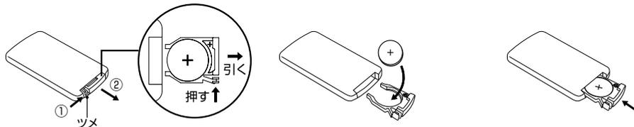
※ 長時間使わないときは電池を取り出してください。(液漏れによる故障を防ぎます)
