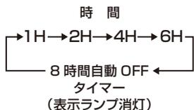
※この商品は、切り忘れ防止のための8時間自動OFFタイマーを搭載しています。切タイマーを設定していなくても、最後に操作してから8時間経過すると自動的に運転を停止します。なお、この機能は解除できません。
