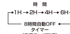
※この商品は、切り忘れ防止のための8時間自動OFFタイマーを搭載しています。切タイマーを設定していないなくても、最後に操作してから8時間経過すると自動的に運転を停止します。なお、この機能は解除できません。
