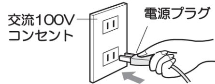
コンセントに電源プラグを差し込み、温度調節つまみを「強」に合わせる
