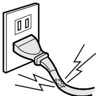
● 電源コードを傷付けたり、破損したり、加工したり、無理に曲げたり、引張ったり、ねじったり、たばねたり、高温部に近づけたりしないでください。また、重い物を載せたり、挟み込んだり、加工したりすると電源コードが破損し、火災・感電の原因となります。
