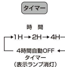
※この商品は、切り忘れ防止のための4時間自動OFFタイマーを搭載しています。タイマーを設定していないなくても、最後に操作してから4時間経過すると自動的に運転を停止します。なお、この機能は解除できません。
