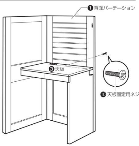
⑩背面パーテーション裏面のネジ穴から⑩天板固定用ネジを差し込み、⑤天板を固定します。
