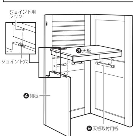
3 天板裏面のジョイント用フックを4 側板と9 天板取付用棧のジョイント穴に差し込み、後方へ押し下げながら固定します。
