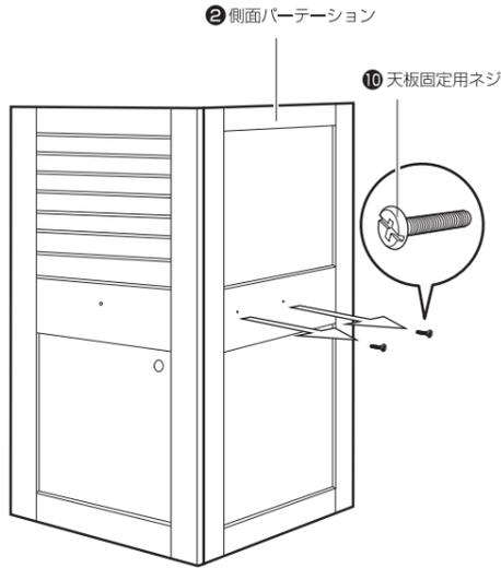
⑨側面パーテーション裏面の⑨天板取付用ネジを外します。
