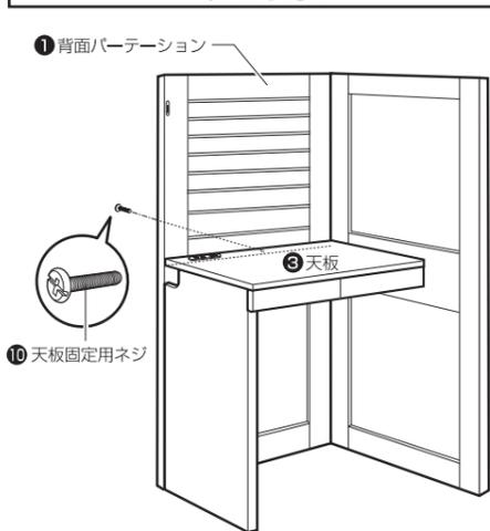
1 背面パーテーション裏面のネジ穴から10 天板固定用ネジを差し込み、3 天板を固定します。
