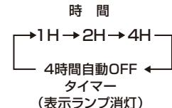
※この商品は、切り忘れ防止のための4時間自動OFFタイマーを搭載しています。タイマーを設定していなくても、最後に操作してから4時間経過すると自動的に運転を停止します。なお、この機能は解除できません。
