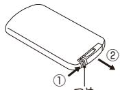
2. 電池を電池ケースに正しく入れます。必ずプラス(+)面を上にしてください。
