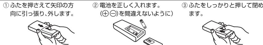
※長時間使わないときは電池を取り出してください。(液漏れによる故障を防ぎます)
