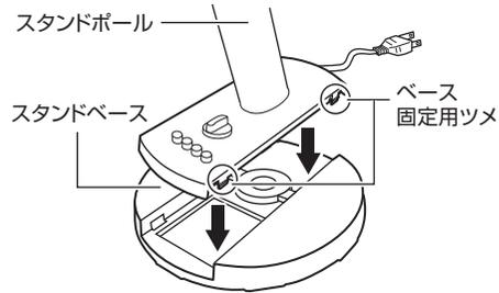
③固定リングをスタンドポール底部に取り付け、時計方向に回して締め付け、確実に固定する。
