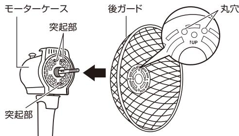
②ガード締付ナットを「しまる」(時計回り)方向へ回し、後ガードを確実に固定する。
