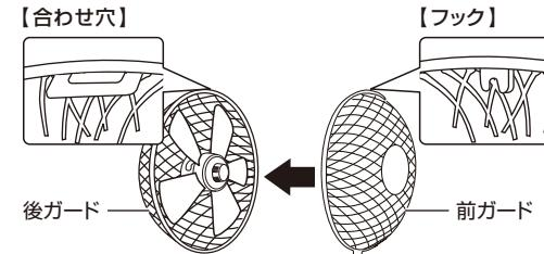
②前ガードのガードリングにあるツメの溝を、上から順に後ガードの外枠に両手で押し込み、確実にはめ込む。最後にクリップで後ガードを挟み込むように止める。
