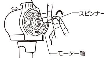
②モーター軸の保護チューブと、ガード締付ナットを外す。
