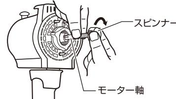
②モーター軸の保護チューブと、ガード締付ナットを外す。
