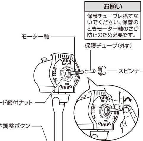
**3** 後ガード・ガード締付ナット・羽根・スピナーナーを取り付けます。
