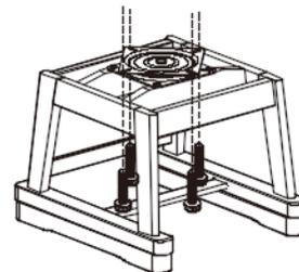
2. 座面の裏側と回転盤との穴位置を合わせ、組立ボルトを仮止めします。4箇所仮止めが終わったら、六角レンチできつく締めてください。
