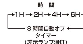
※この商品は、切り忘れ防止のための8時間自動オフタイマーを搭載しています。切タイマーを設定していくなくても、最後に操作してから8時間経過すると自動的に運転を停止します。なお、この機能は解除できません。
