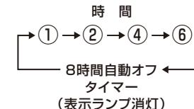
※この商品は、切り忘れ防止のための8時間自動オフタイマーを搭載しています。切タイマーを設定していないなくても、最後に操作してから8時間経過すると自動的に運転を停止します。なお、この機能は解除できません。
