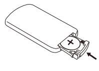
※長時間使わないときは電池を取り出してください。(液漏れによる故障を防ぎます)
