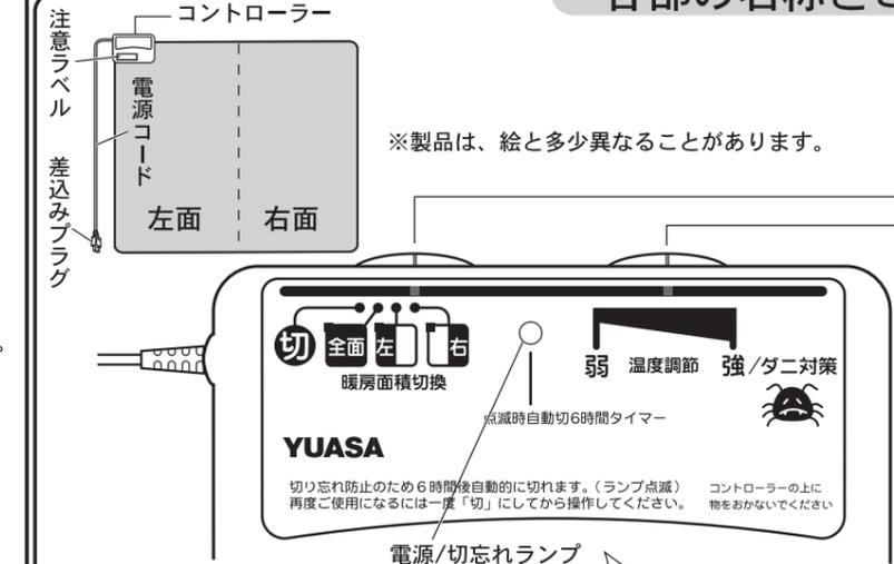
『電源/暖房面積切換スイッチ』を入れると自動的に『切忘れタイマー』がスタートします。6時間経過すると、タイマーが働いて通電が止まり、『電源/切忘れランプ』が点滅してお知らせします。通電が止まった後も続けてご使用になるときは、1度『電源/暖房面積切換スイッチ』を切ってから再度『電源/暖房面積切換スイッチ』を入れ直してください。さらに6時間ご使用いただけます。
