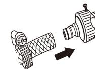
④ ホースバンドを下記イラスト位置まで移動させ、ドライバーで固定ネジを時計回りの方向に回し、確実に固定してください。
