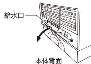
② 水タンクのMAXの位置まで水道水を給水します。
