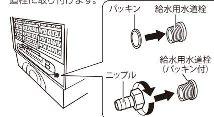
・取り付け後、時計回りの方向にニップルを回し、確実に固定してください。
